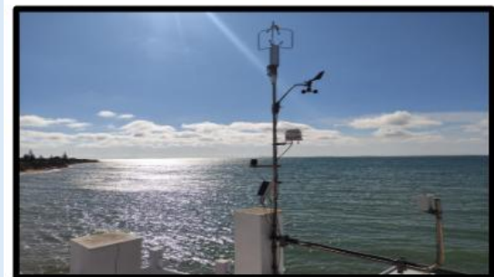
Estación meteorológica automática + anemómetro sónico 3D
