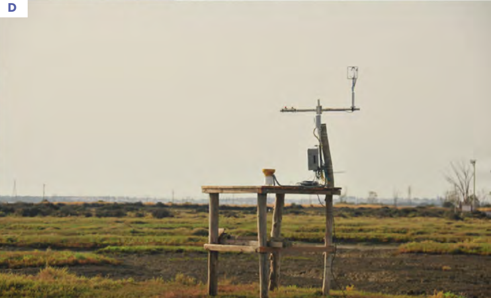
Figura 2. A y B) Diferentes tipos de cámaras bentónicas que permiten medir el metabolismo del sedimento o de las plantas de marismas. C) Boya multiparamétrica instalada en la Bahía de Cádiz para el seguimiento continuo de variables físicas y biogeoquímicas de la columna de agua. D) Torre de covarianza de remolinos instalada en una zona intermareal para la medición continua de los flujos de CO 2 .
