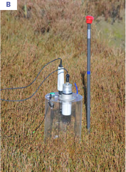
Figura 2. A y B) Diferentes tipos de cámaras bentónicas que permiten medir el metabolismo del sedimento o de las plantas de marismas. C) Boya multiparamétrica instalada en la Bahía de Cádiz para el seguimiento continuo de variables físicas y biogeoquímicas de la columna de agua. D) Torre de covarianza de remolinos instalada en una zona intermareal para la medición continua de los flujos de CO 2 .
